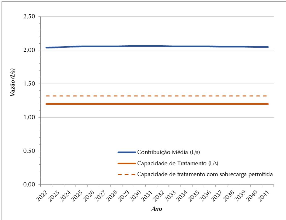
Figura 8.9 – Contribuição Média Total (L/s) x Capacidade de Tratamento de Esgoto (L/s) – SES Jatobá
