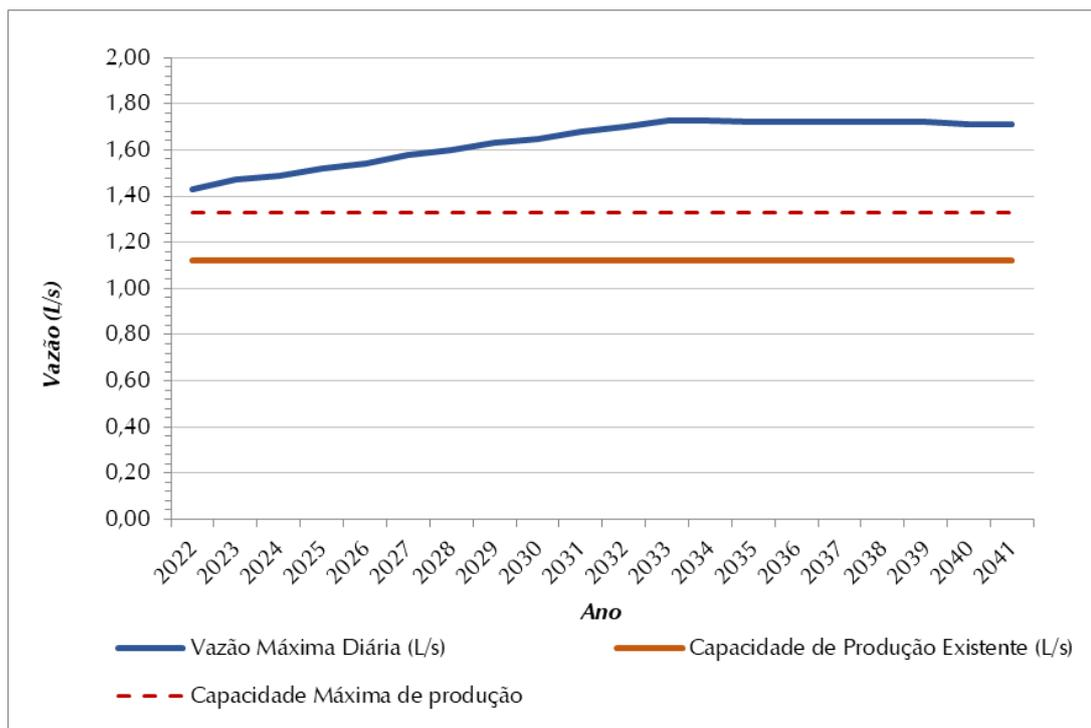
**Figura 8.3 – Demandas Máximas Diárias (L/s) X Vazão Captada (L/s) – SAA Jatobá**
