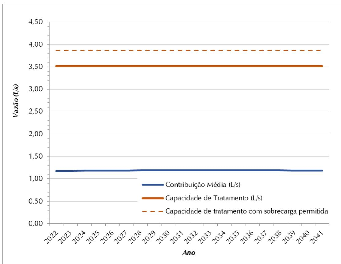
Figura 8.11 – Contribuição Média Total (L/s) x Capacidade de Tratamento de Esgoto (L/s) – SES São Martinho d'Oeste
