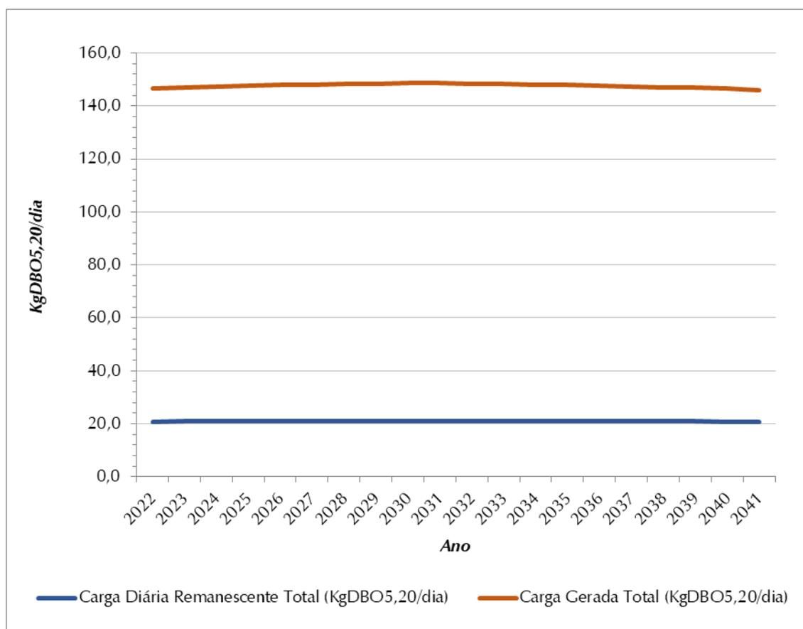
**Figura 8.8 - Evolução de Cargas Orgânicas (Kg DBO<sub>5,20</sub>/Dia)**
