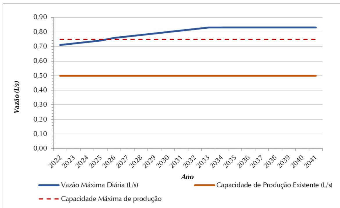
**Figura 8.5 – Demandas Máximas Diárias (L/s) X Vazão Captada (L/s) – SAA São Martinho d'Oeste**
