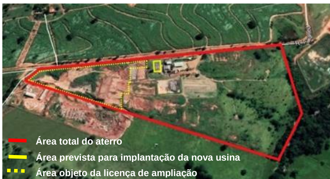
Figura 56: Identificação das áreas para disposição de rejeitos.
