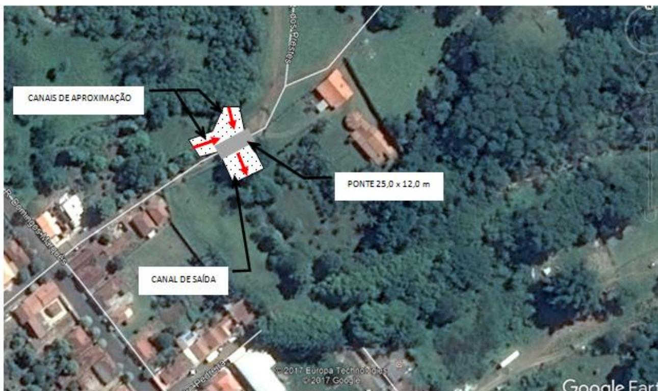
**Ilustração 8.23 – Esquema da solução proposta para o Ponto 5.**
