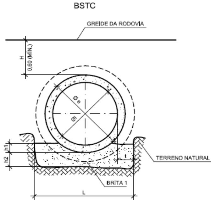
Ilustração 8.20 – Assentamento de tubos de concreto
