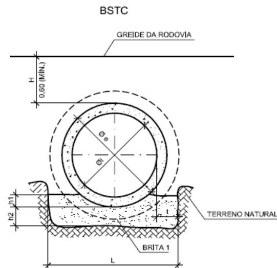
Ilustração 8.7 – Assentamento de tubos de concreto
