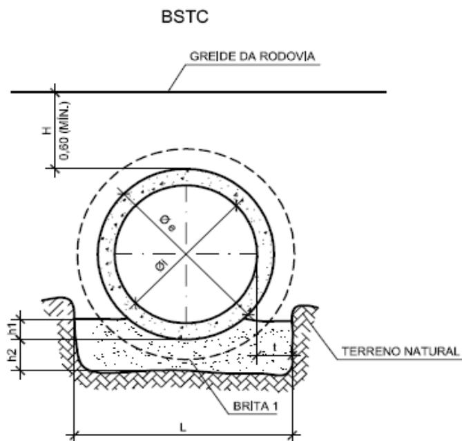
Ilustração 8.9 – Assentamento de tubos de concreto
