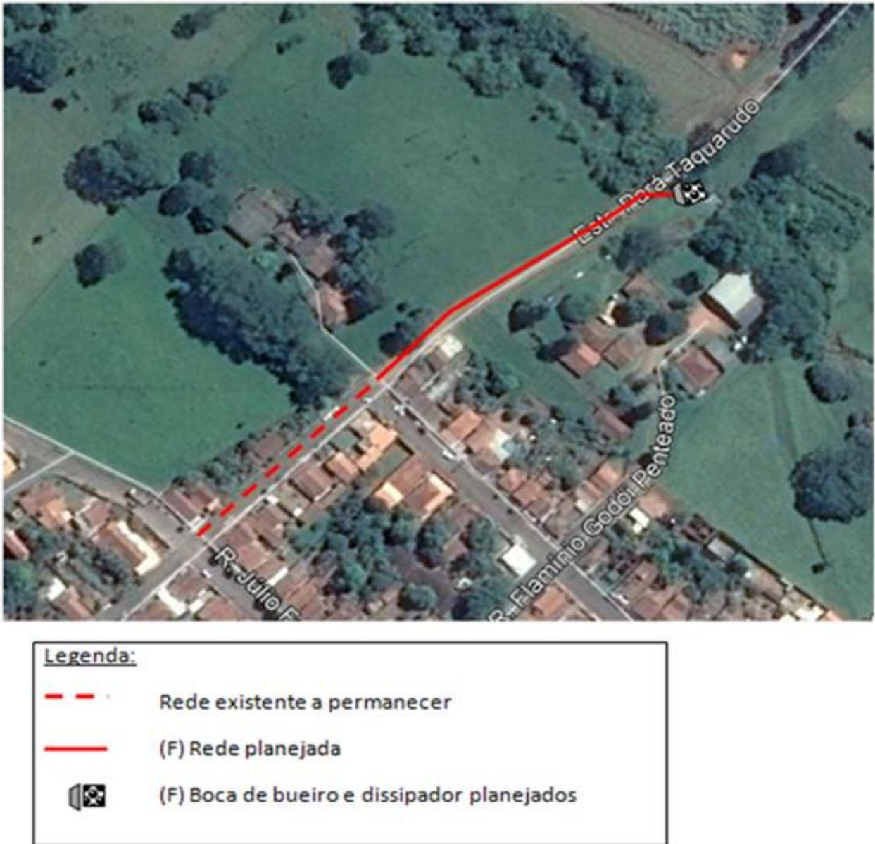
**Ilustração 8.15 – Esquema das intervenções planejadas para o Ponto 3**
