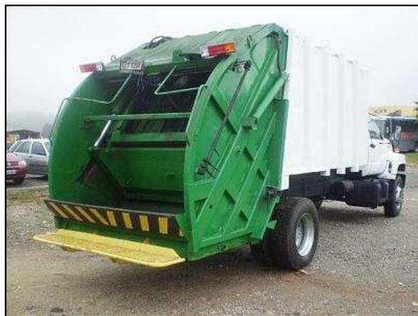
Figura 7 – Caminhão coletor compactador de resíduos.
