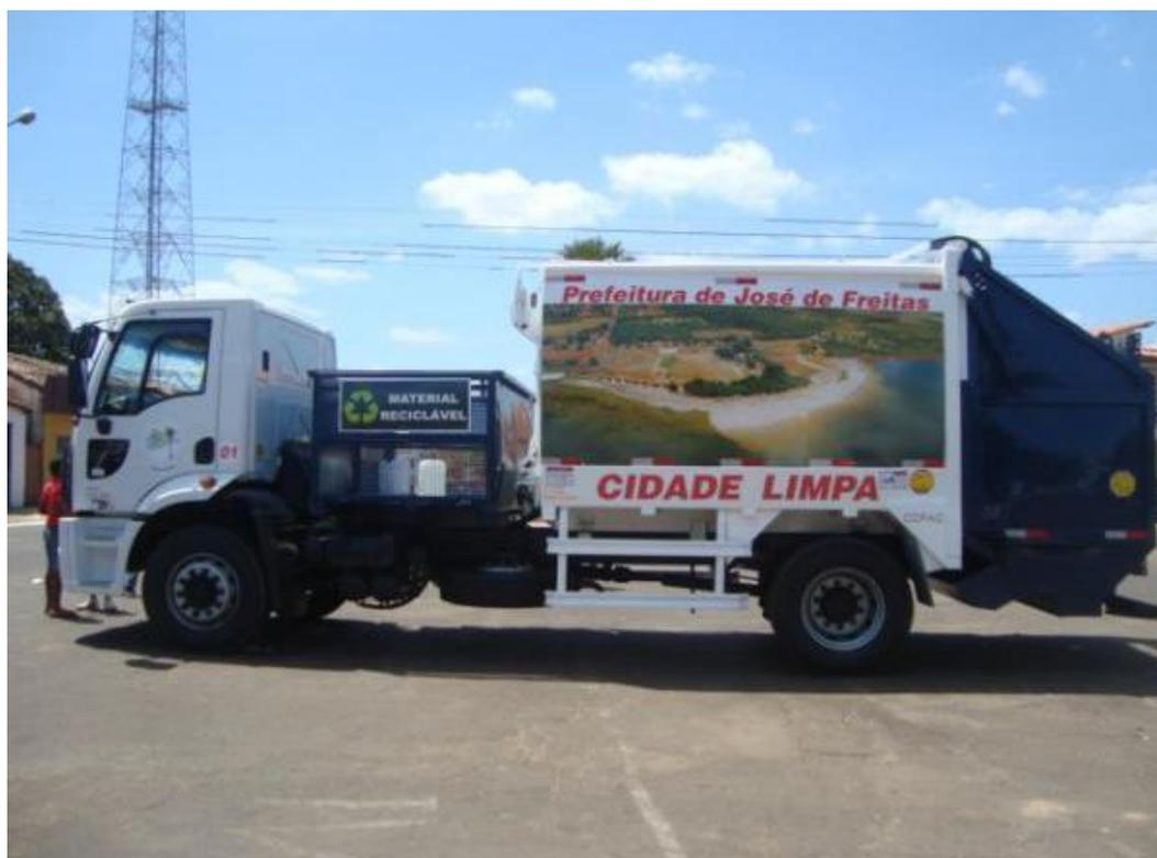
Figura 33. Caminhão compactador com compartimento para recicláveis.
