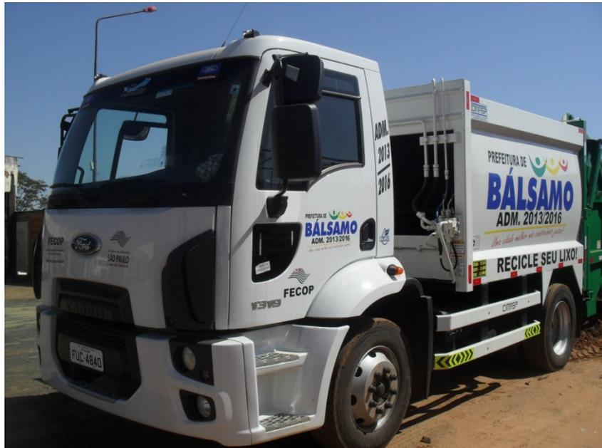
**Figura 2:** Caminhão compactador ano 2014, utilizado na coleta dos resíduos domiciliares.
