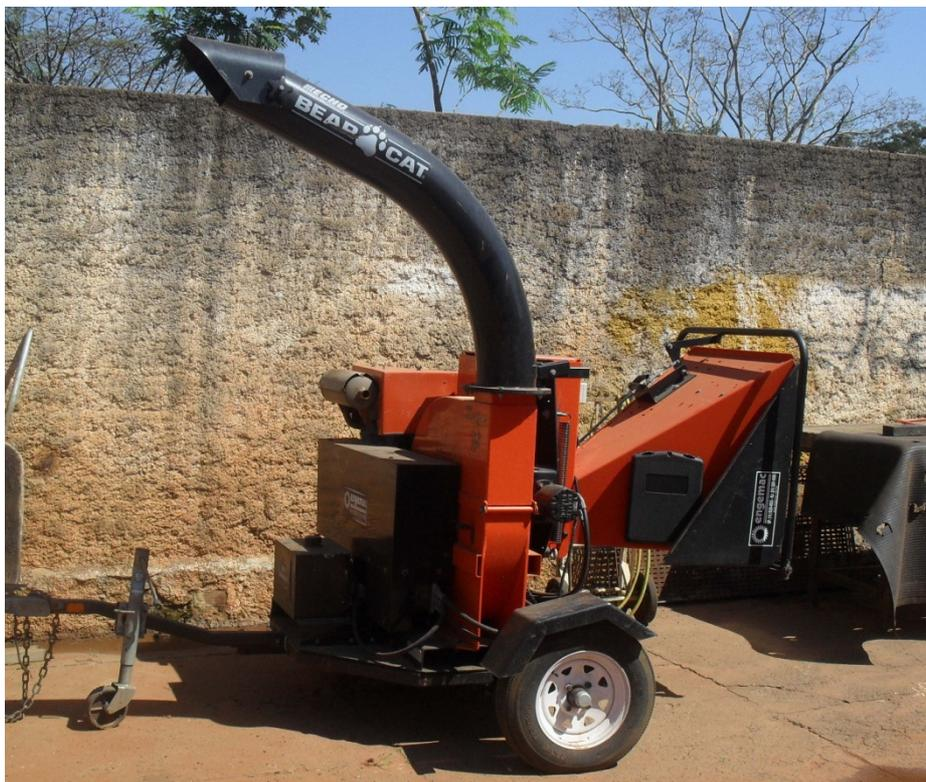
**Figura 9:** Triturador de galhos sem funcionamento devido a necessidade de reparos e concertos elétricos e mecânicos.
