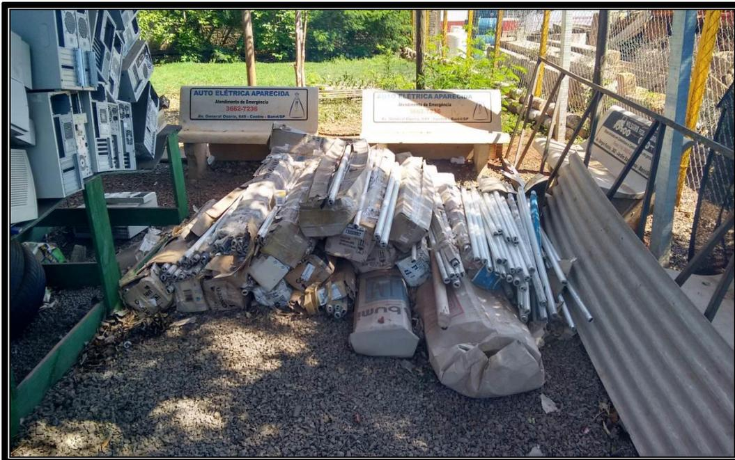
**Foto 06:** Lâmpadas fluorescentes aguardando para remessa. A área não está impermeabilizada e parcialmente descoberta.
