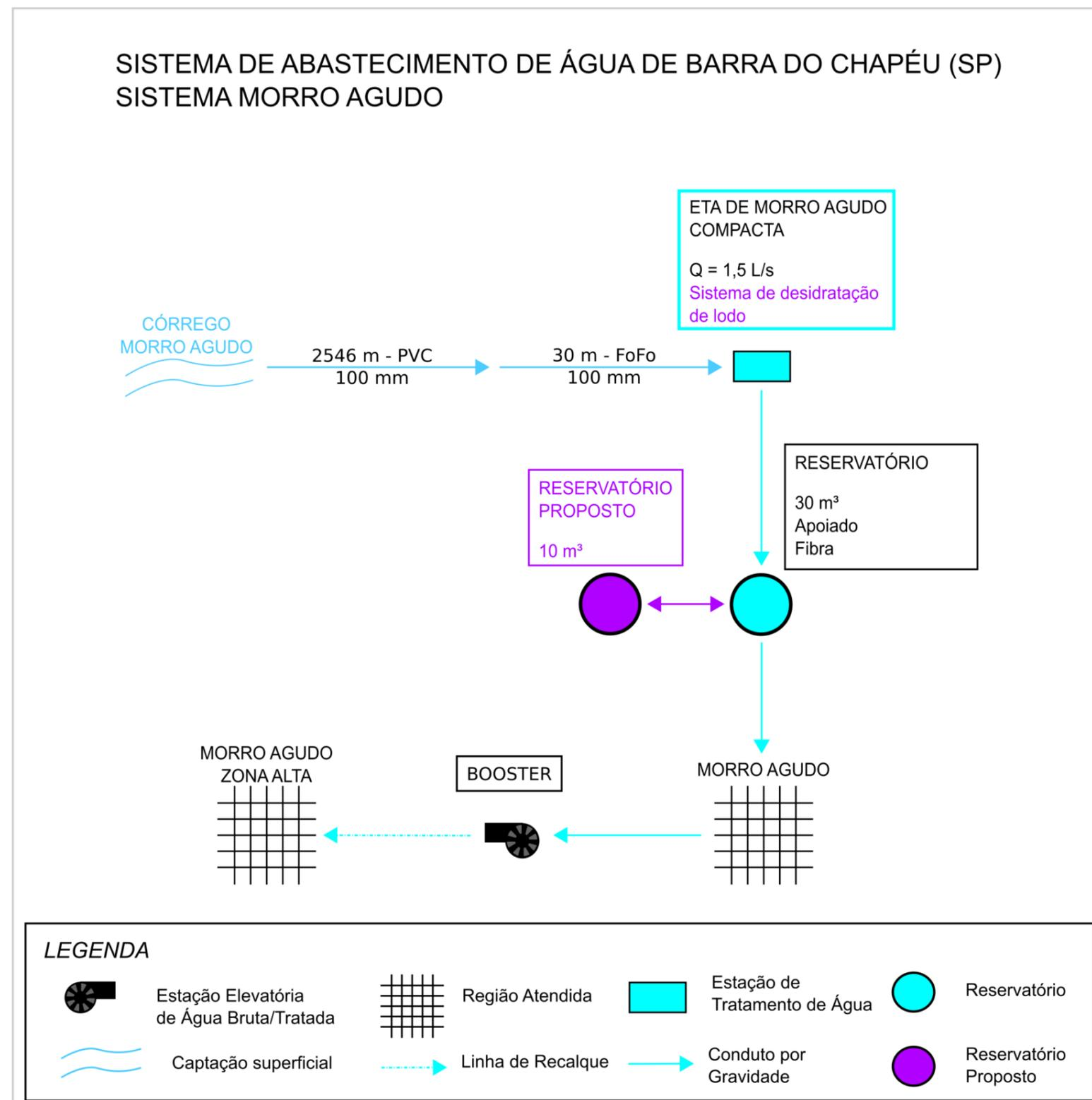
Figura 10.2 – Croqui do sistema de abastecimento de água proposto para Morro Agudo
