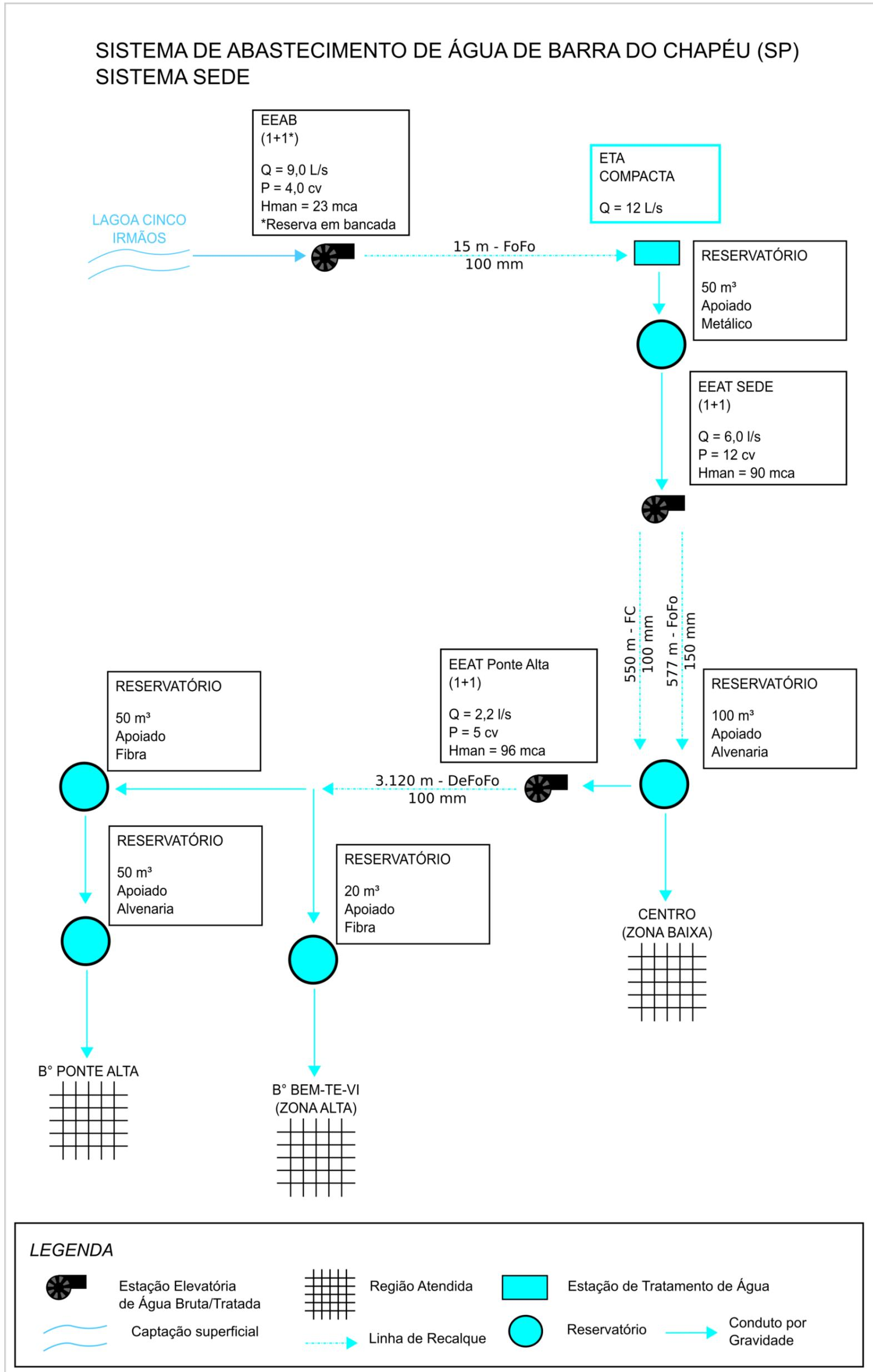
Figura 4.1 – Croqui do Sistema de Abastecimento de Água Sede
