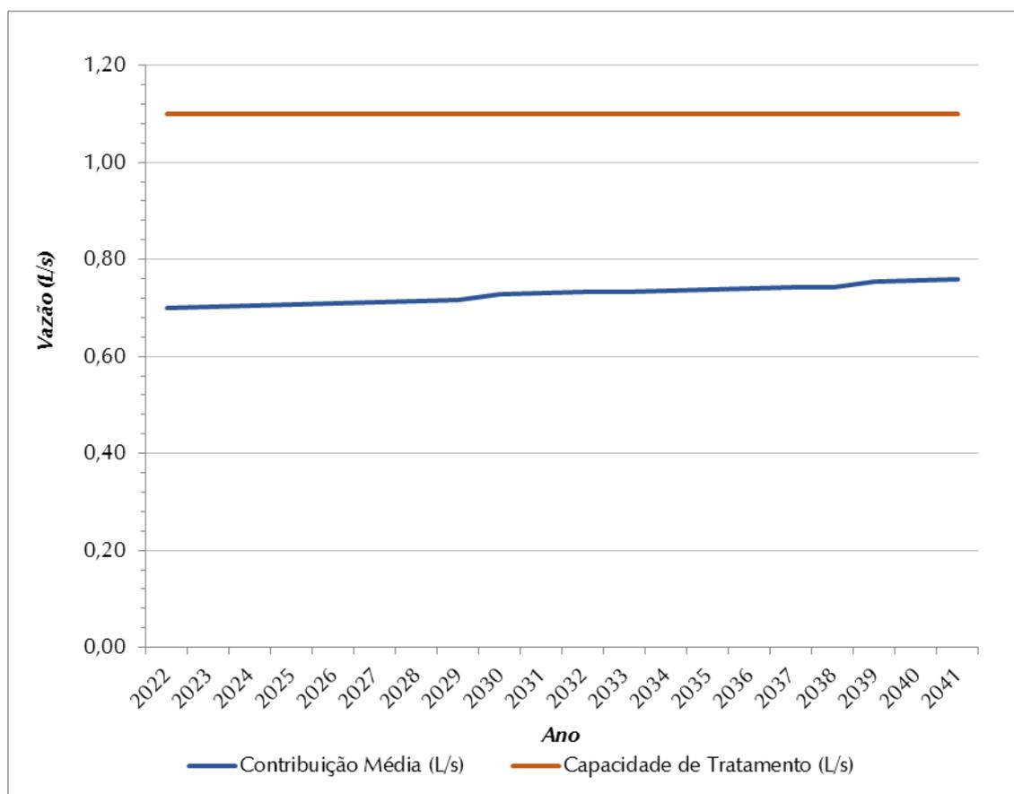
**Figura 8.9 – Contribuição Média Total (L/s) x Capacidade de Tratamento de Esgoto (L/s) – SES Morro Agudo**
