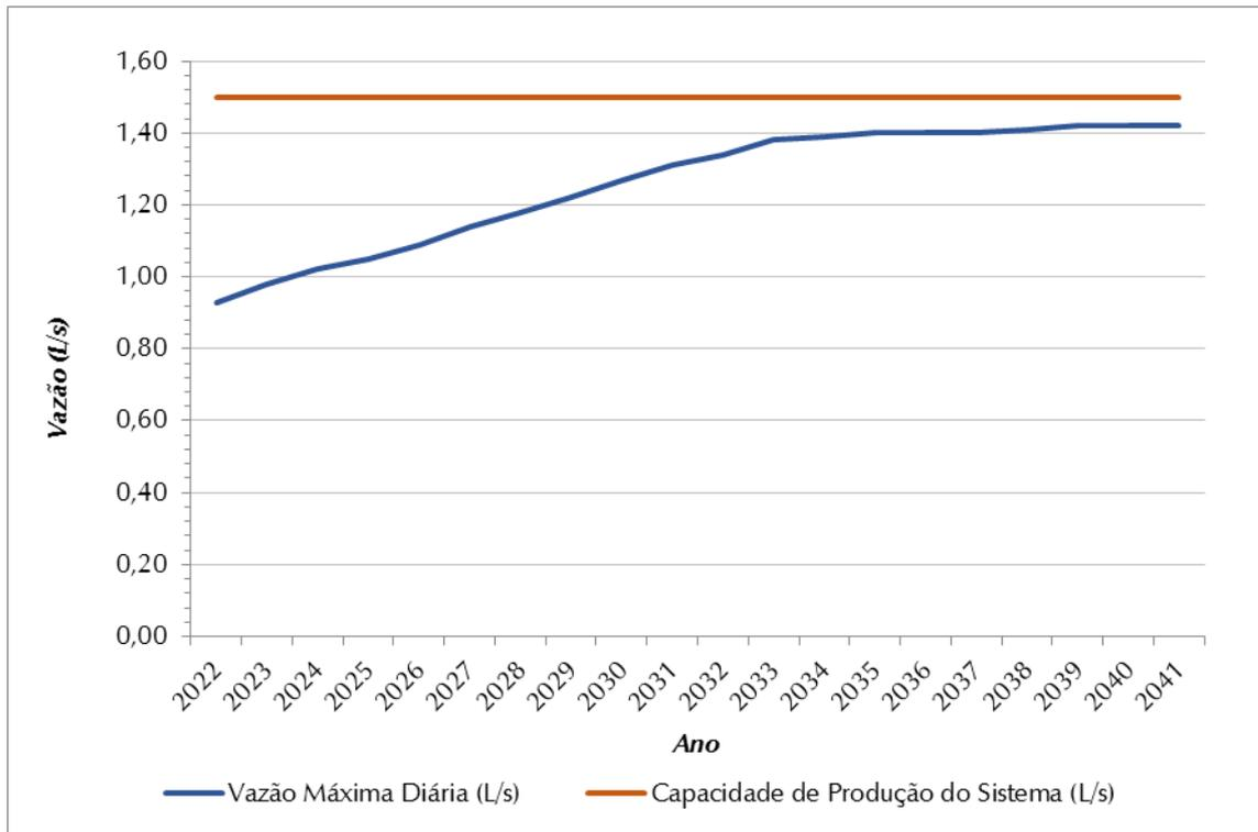
**Figura 8.3 – Demandas Máximas Diárias (L/s) X Vazão Captada (L/s) – SAA Morro Agudo**
