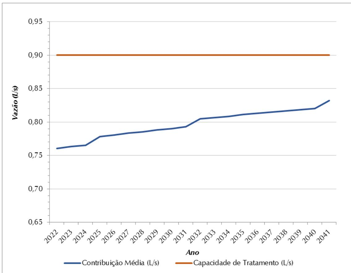
Figura 8.7 – Contribuição Média Total (L/s) x Capacidade de Tratamento de Esgoto (L/s) – SES Ponte Alta
