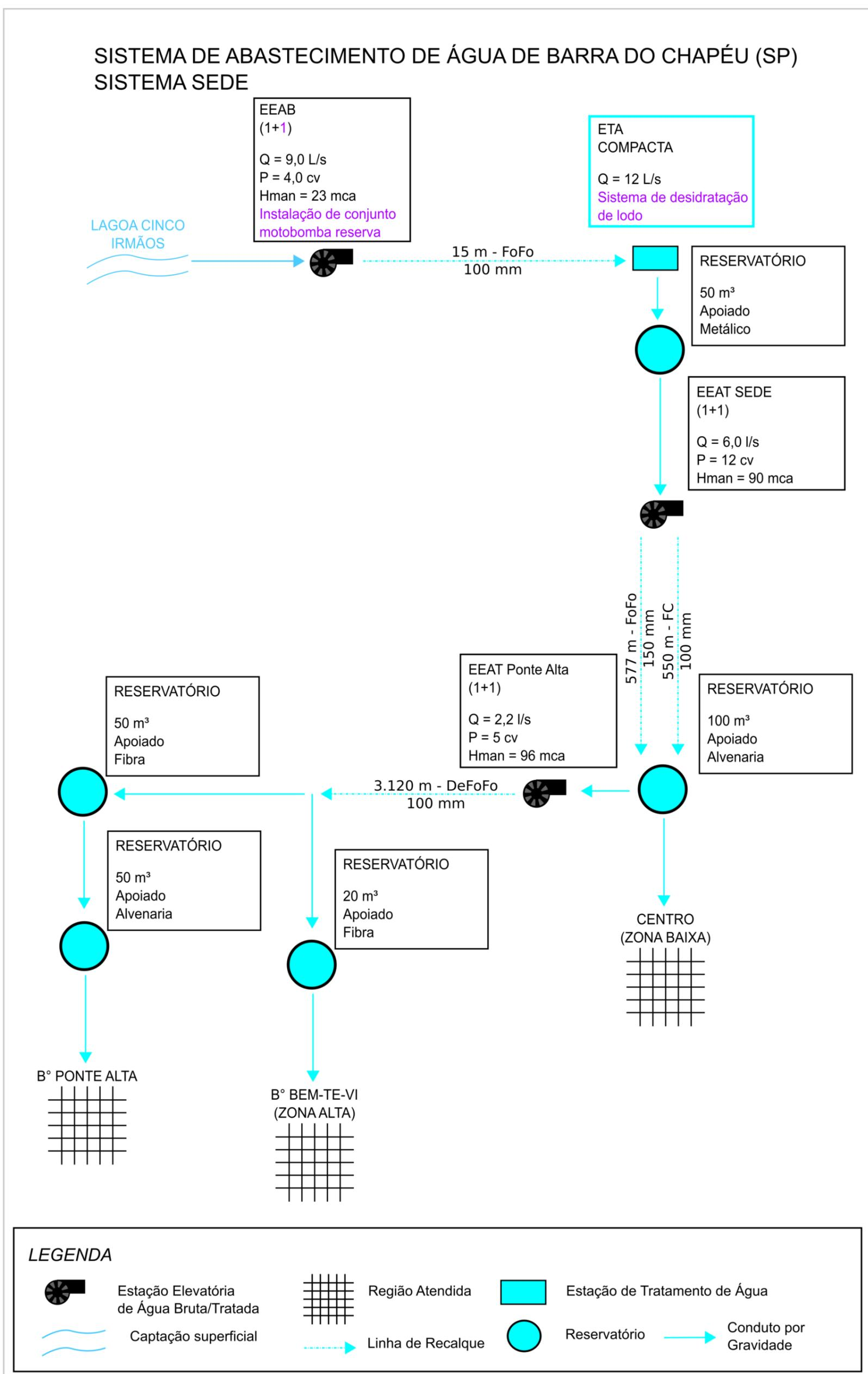
Figura 10.1 – Croqui do sistema de abastecimento de água proposto para Sede
