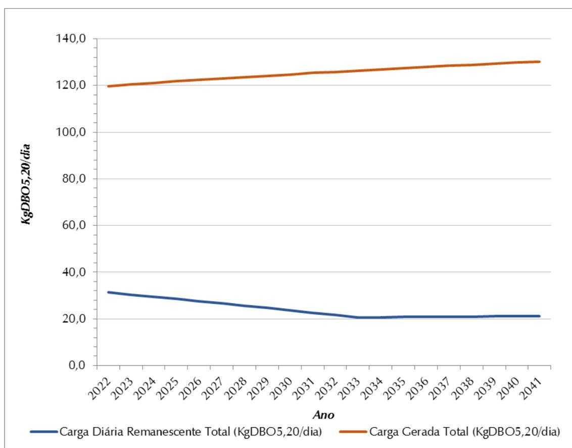
**Figura 8.6 - Evolução de Cargas Orgânicas (Kg DBO<sub>5,20</sub>/Dia)**
