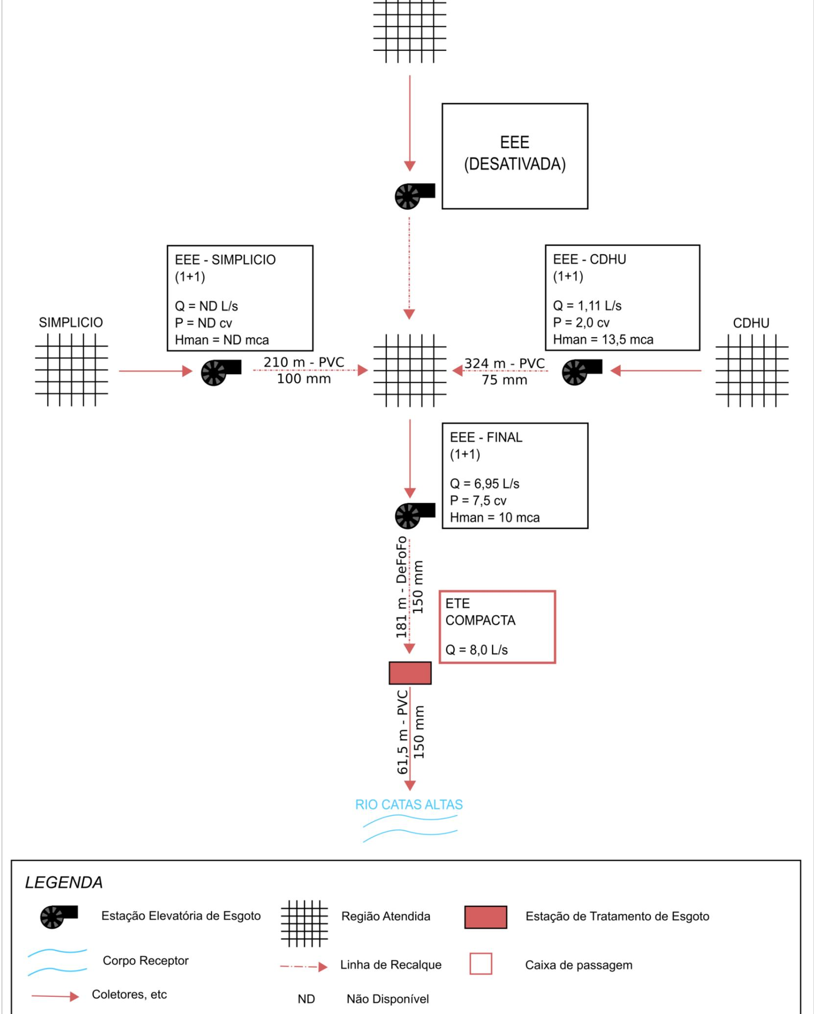
Figura 4.3 – Croqui do Sistema de Esgotamento Sanitário da Sede de Barra do Chapéu
