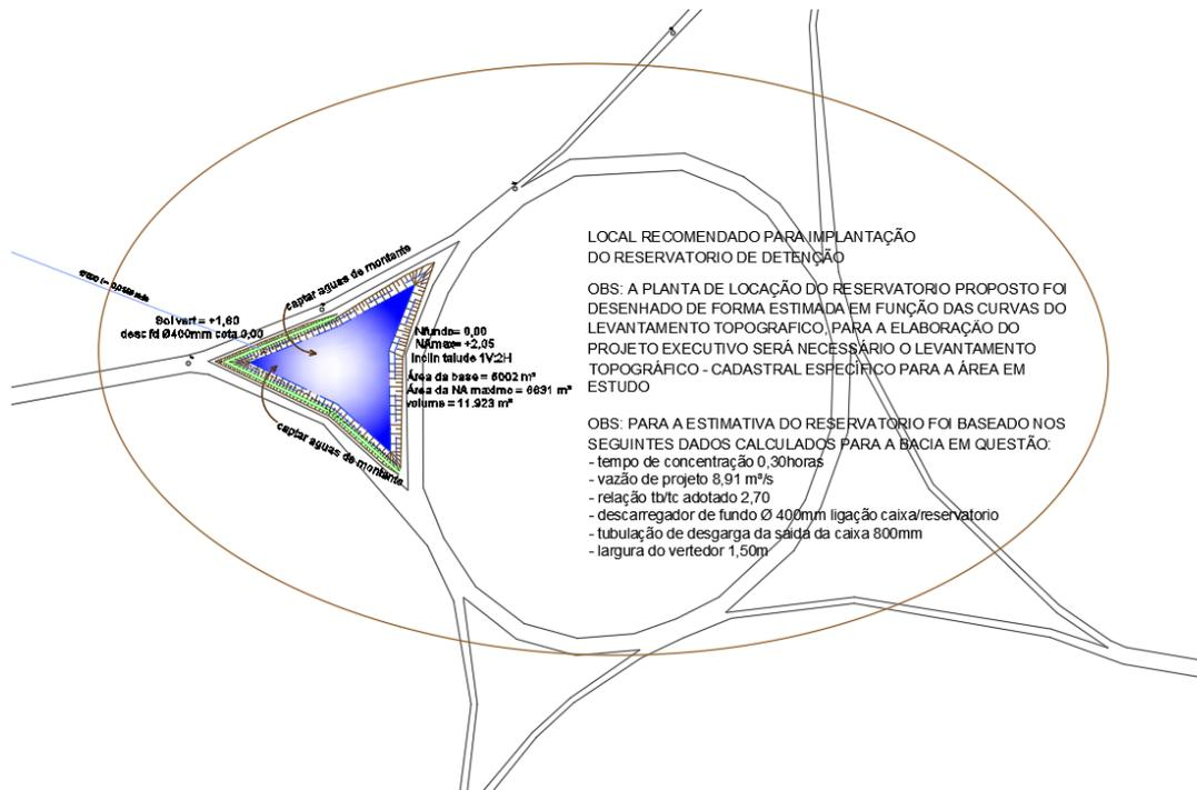
Figura 3.1 - Área de possível implantação da bacia de detenção
