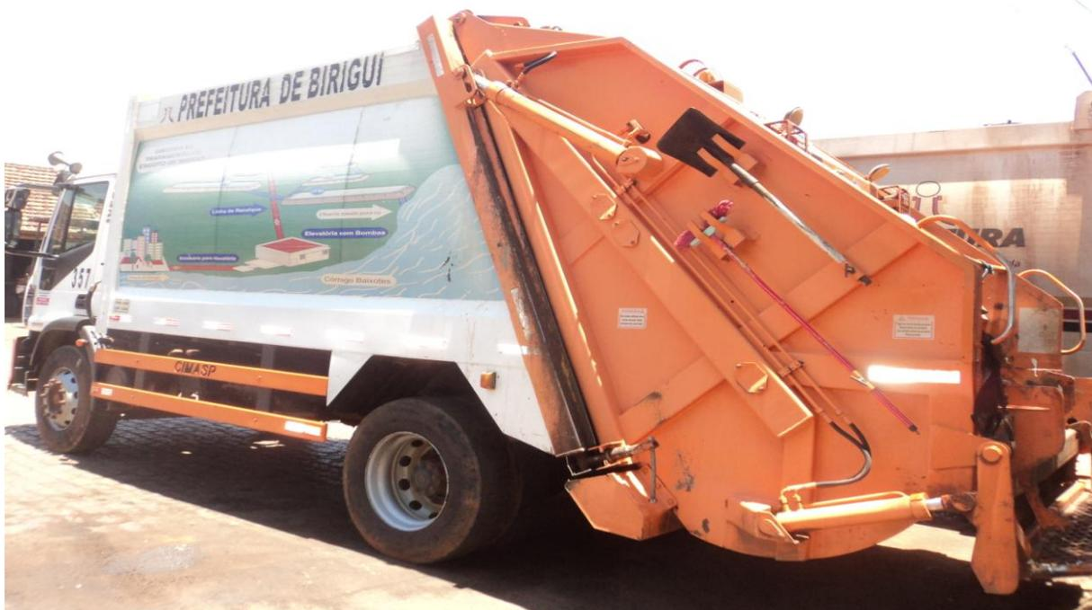
**Figura 08** - Caminhão coletor compactador
