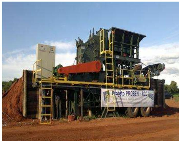
FIGURA 11: Equipamento de beneficiamento de resíduos da construção civil.
