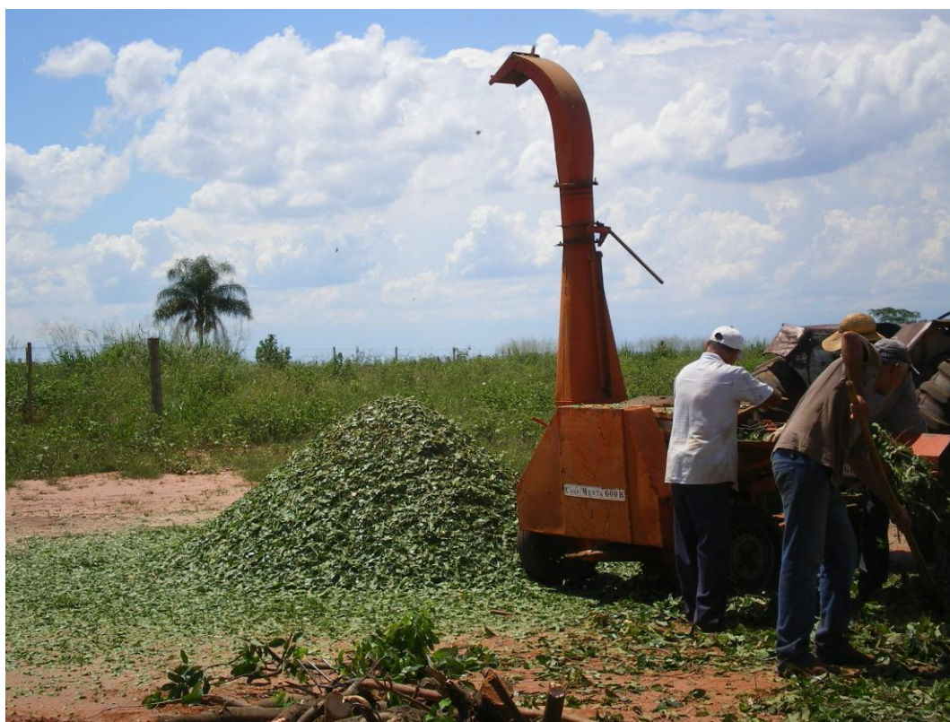
FIGURA 04 – Resíduos de Podas de Árvores sendo triturados
