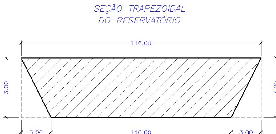
Figura 18 – Seção Trapezoidal do Reservatório
