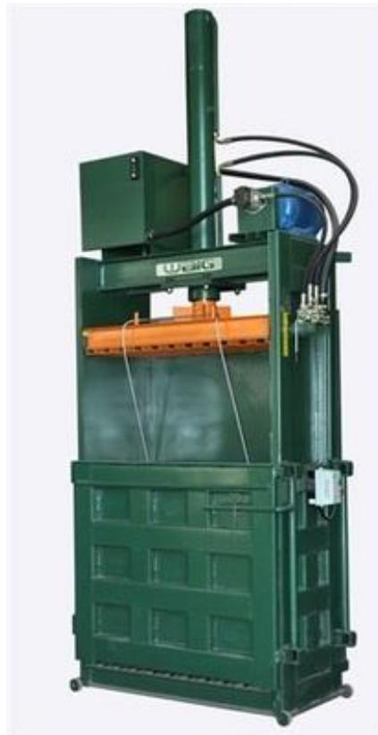
**Figura 25 – Prensa Utilizada na Prensagem e Compactação dos Resíduos.**
