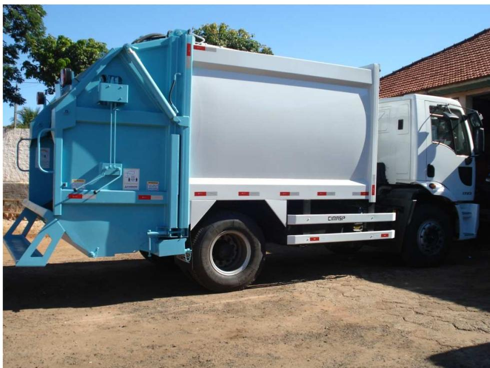
**Figura 25** - Coletor Compactador VW
