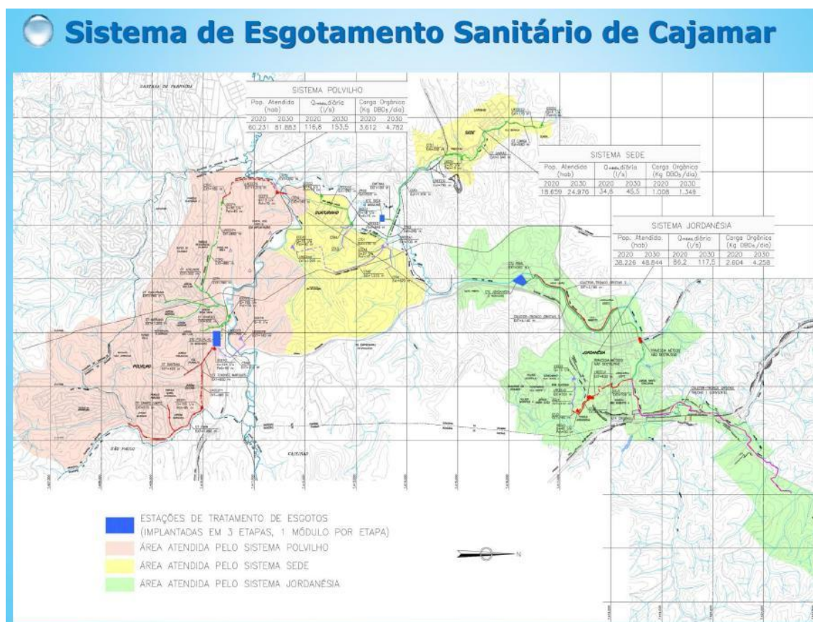
Figura 16 Esquema geral de esgotos de Cajamar
