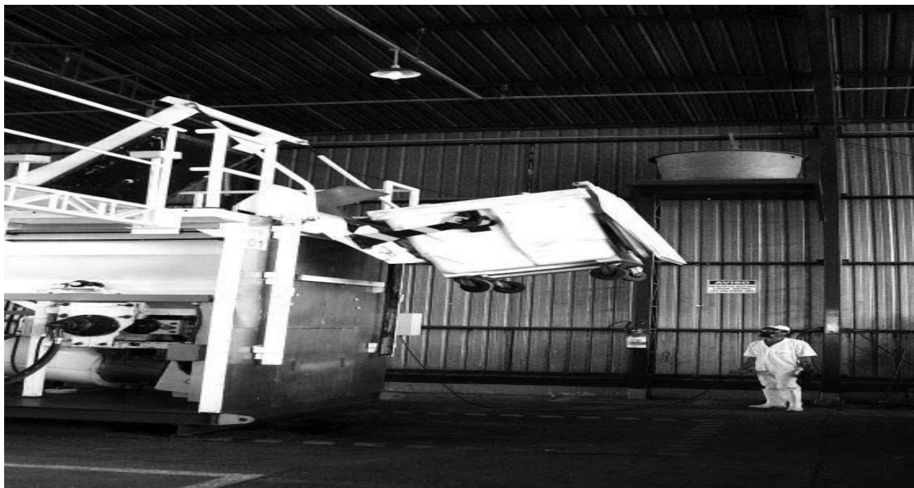
foto - Basculamento de container para o equipamento.
