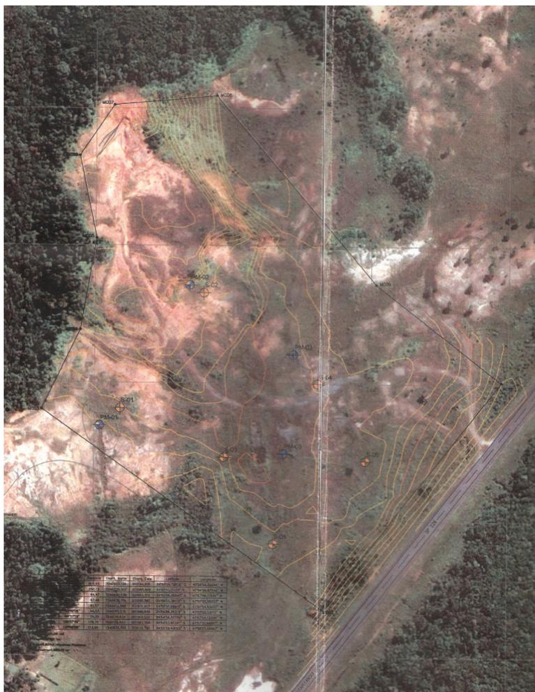
Figura 4. Área em estudo para a implantação do aterro sanitário de Cananeia. Na imagem consta a topografia do terreno e estão demarcados os pontos de sondagem.
