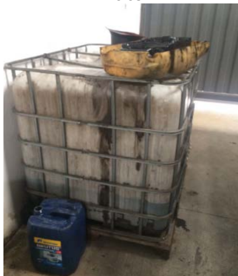
Figura 86. Local de armazenamento dos resíduos de óleos e graxas da Oficina LM Freios
