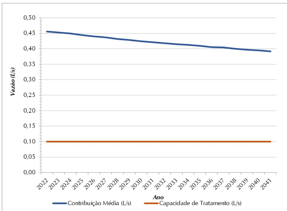
**Figura 8.5 – Contribuição Média Total (L/s) x Capacidade de Tratamento de Esgoto (L/s) – SES Icoarana**
