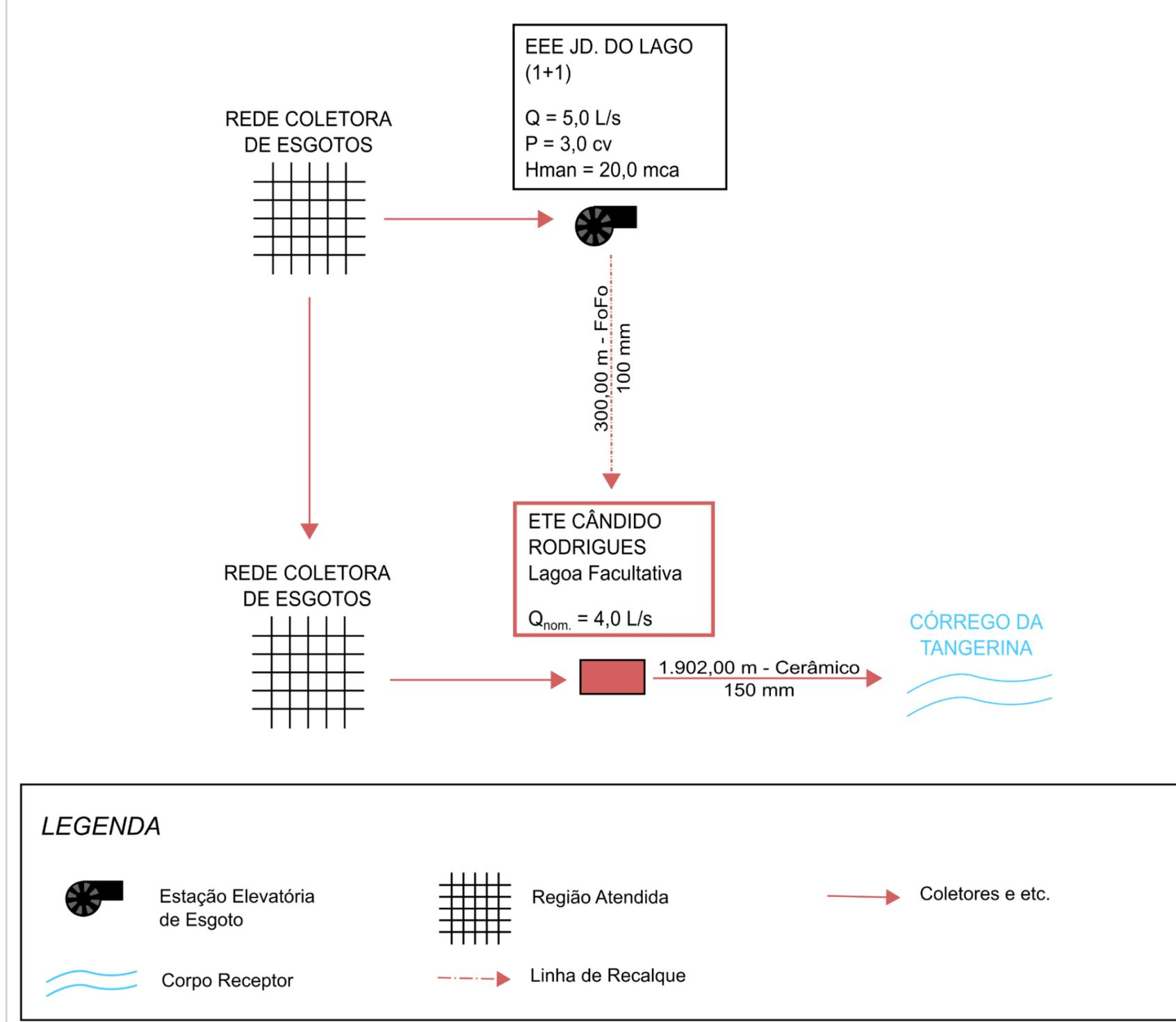
Figura 4.2 – Croqui do Sistema de Esgotamento Sanitário da Sede de Cândia Rodrigues
