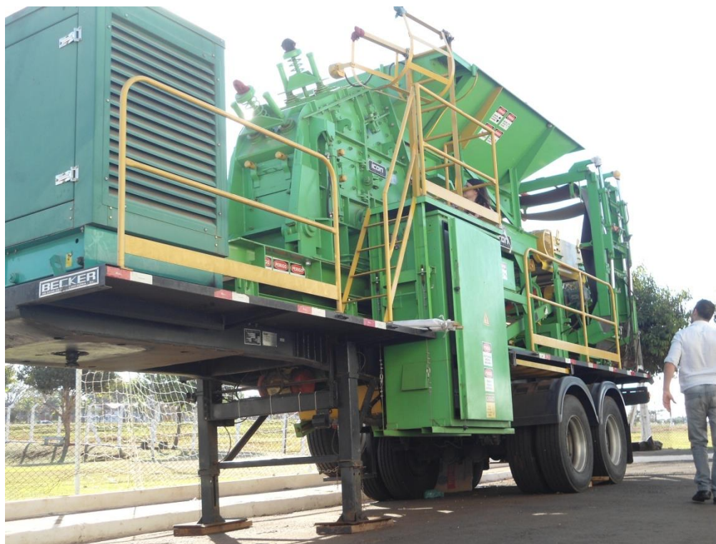
Figura 13 – Máquina de Beneficiar Entulho da UMMES
