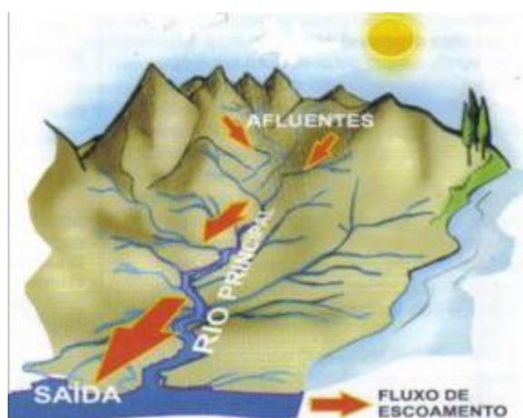
Figura 6 – Ilustração do Conceito de Bacia Hidrográfica
