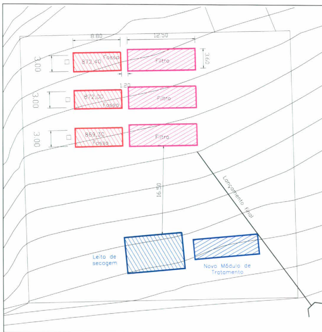
Figura 6 - Lay-out sugerido da futura ETE
