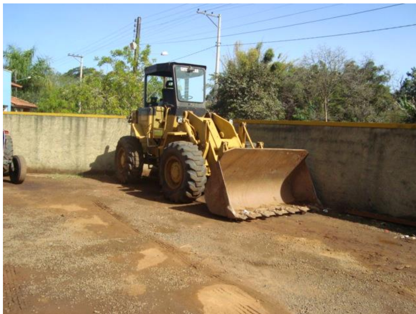
Figura 4.4 – Pá Carregadeira – utilizada no Aterro em Valas no espalhamento e recobrimento dos resíduos sólidos domésticos.
