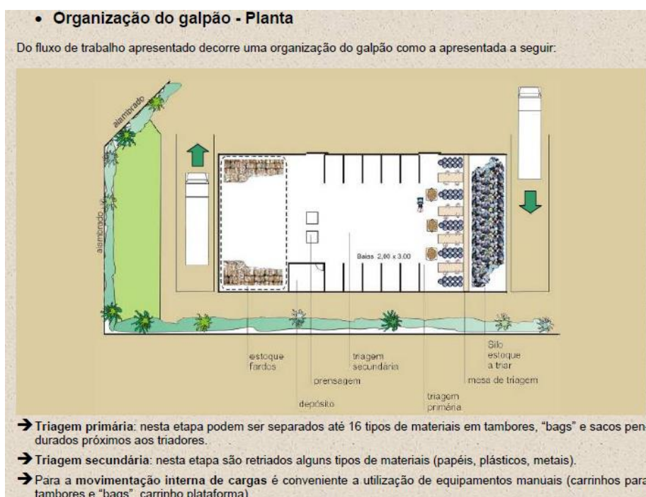
Figura 3.13 – Organização de um Galpão de Triagem.
