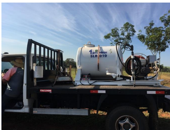
Foto 3.35 – Caminhão hidrojato utilizado na limpeza dos desarenadores
