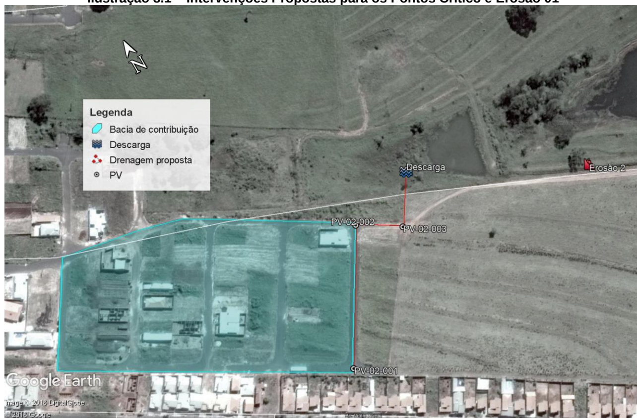
Ilustração 8.2 – Intervenção Proposta para o Ponto de Erosão 02
