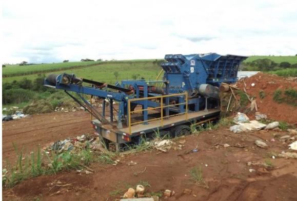
Foto 3.61 – Triturador de resíduos de construção civil – Vista Geral
