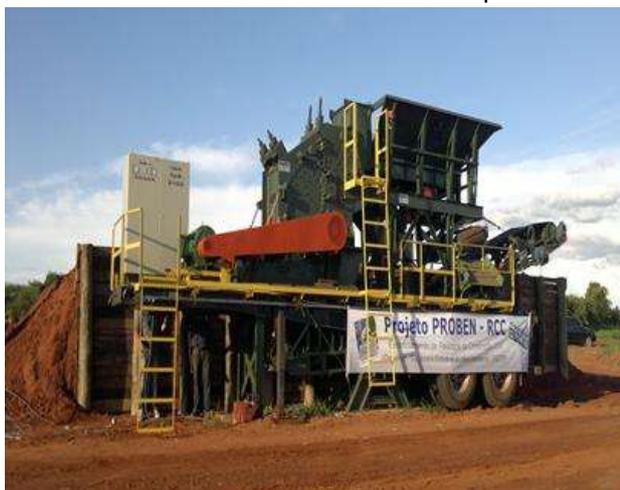
FIGURA 09: Equipamento de beneficiamento de resíduos da construção civil.
