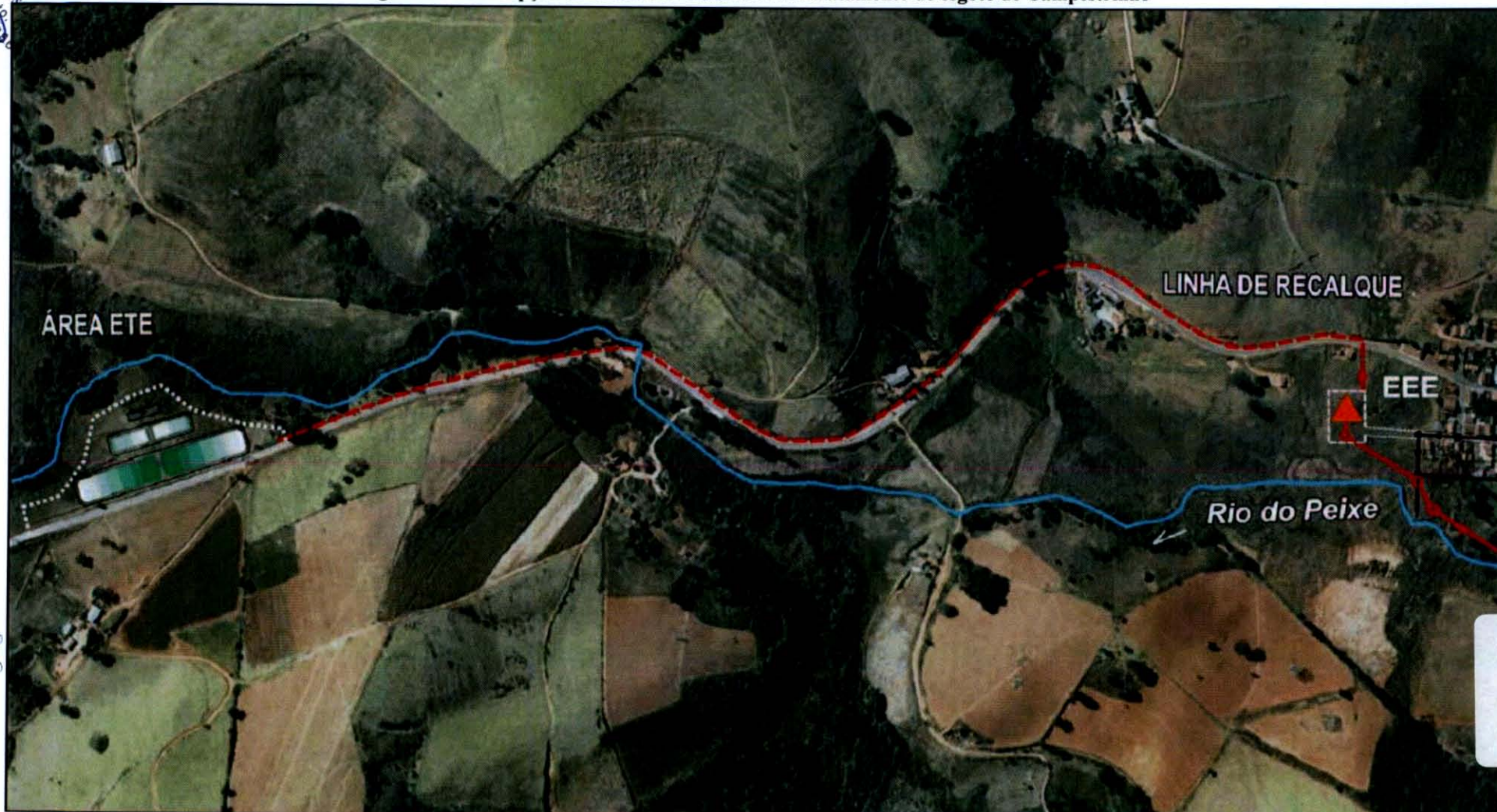
Figura 24 - Concepção do sistema de afastamento e tratamento de esgoto de Campestrinho
