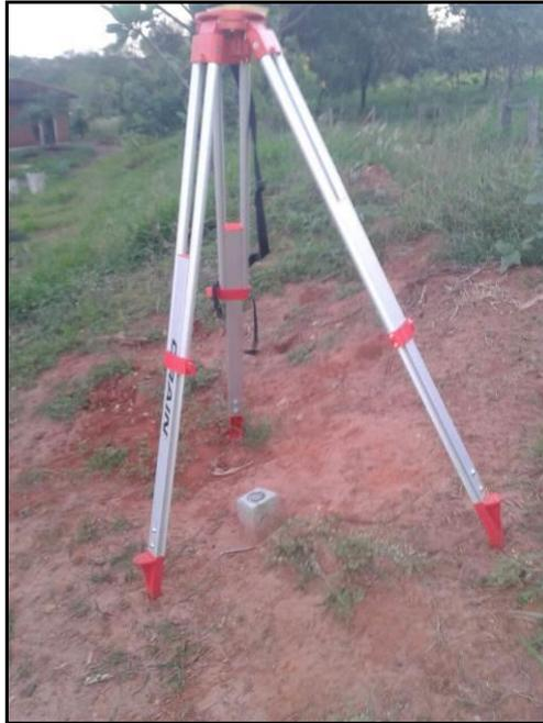
Figura 10 – Marco implantado e base montada
