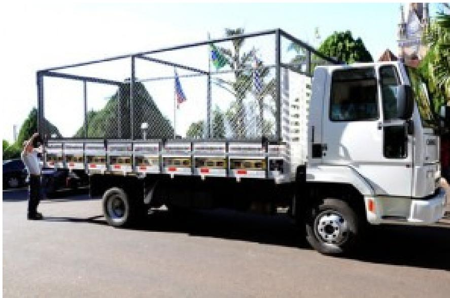
Figura 21 – Caminhão Adequado para Coleta Seletiva.
