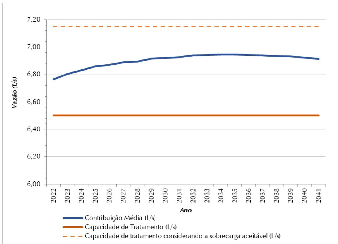
Figura 8.3 – Contribuição Média Total (L/s) x Capacidade de Tratamento de Esgoto (L/s) – SES Sede
