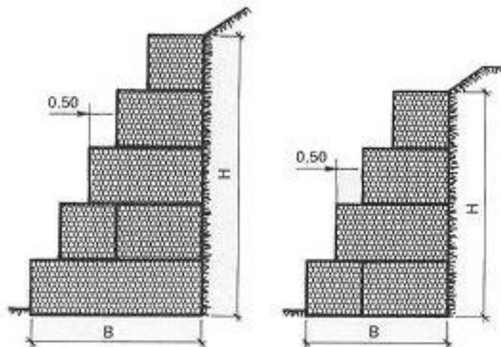
**Ilustração 8.3 –Contenção de taludes com gabião tipo caixa.**
