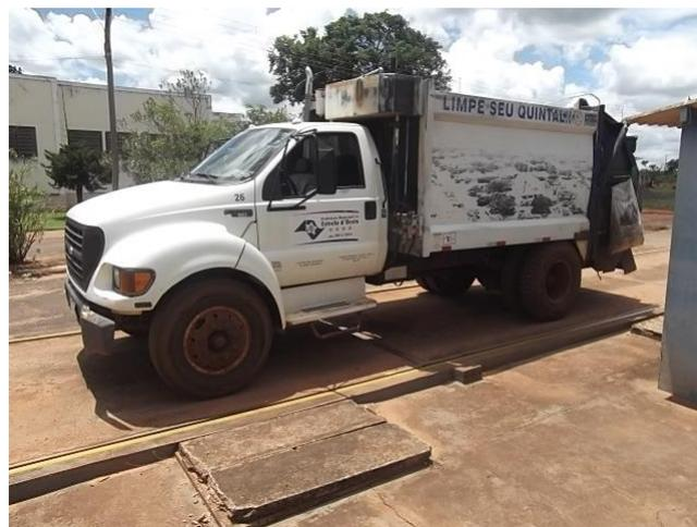
**Figura 4** – Foto durante pesagem de veículo que efetua a coleta regular.
