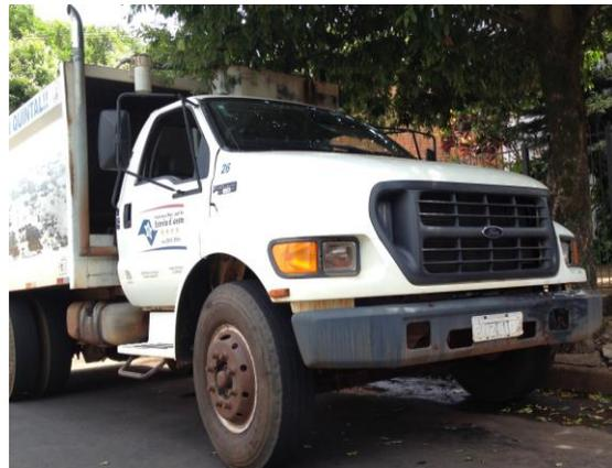
**Figura 7.2** – Caminhão coletor-compactador.
