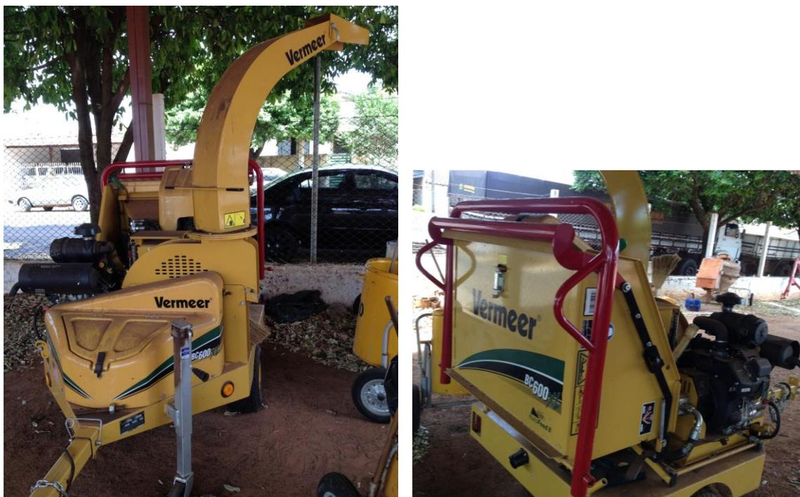
**Figura 7.1** – Máquina trituradora de resíduos de vegetação.
