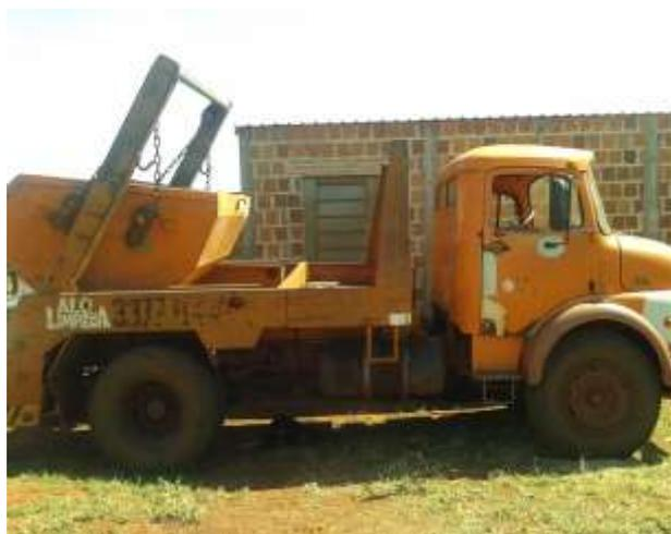
FIGURA 13: Caminhão utilizado para o transporte de caçambas.
