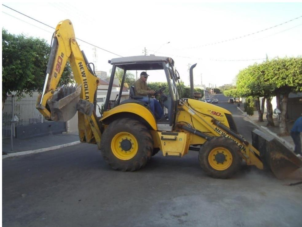
**Figura 46-** Retroescavadeira utilizada na coleta de RCC no Município
