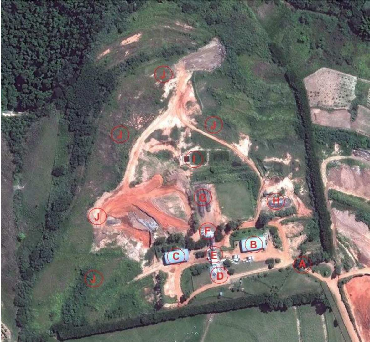
Figura 4: Central de tratamento e disposição final de resíduos sólidos urbanos de Garça: (A) Entrada; (B) Galpão de escritório e oficina; (C) Galpão de enfardamento; (D) Recepção de resíduos; (E) Esteira de triagem; (F) Peneiramento primário e baia de rejeitos; (G) Pátio de compostagem; (H) Beneficiamento de composto; (I) Lagoa de chorume (lixiviado); (J) Área de disposição final de rejeitos.
