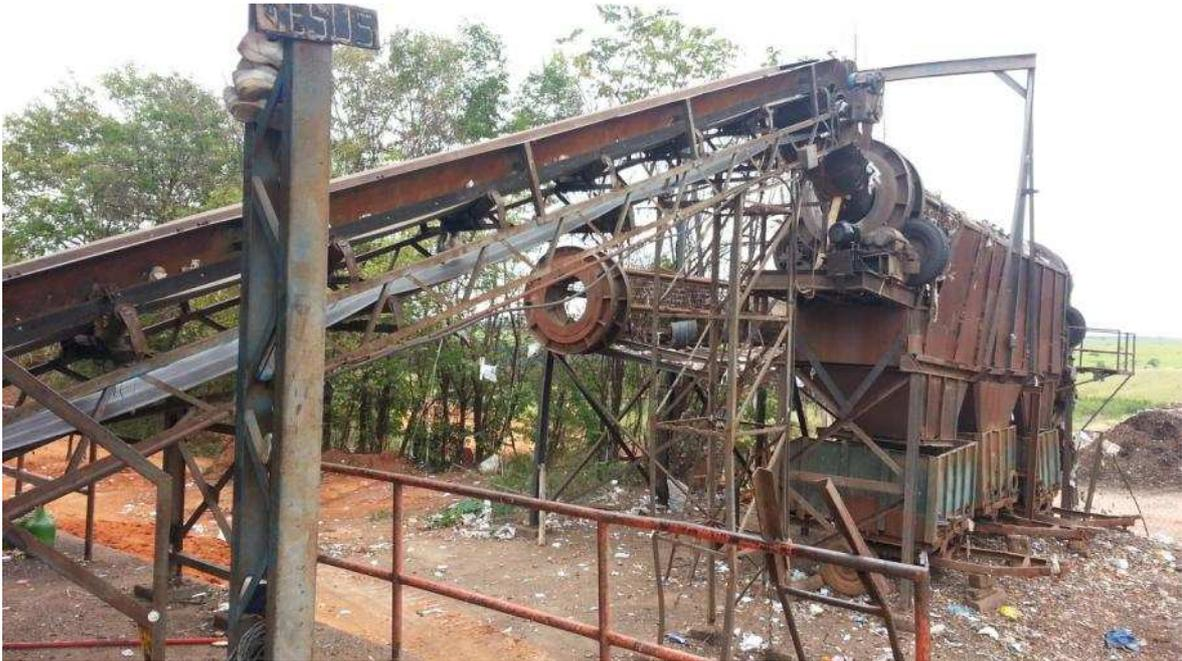
Foto 5: Transportadora de rejeitos da esteira de triagem manual para peneira rotativa.
