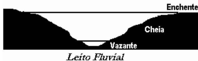
**Fig. 32 – Sucessão sazonal do escoamento em um leito fluvial**
