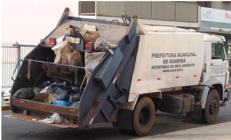
Figura 15 - Caminhão coletor utilizado na coleta convencional de resíduos domésticos
