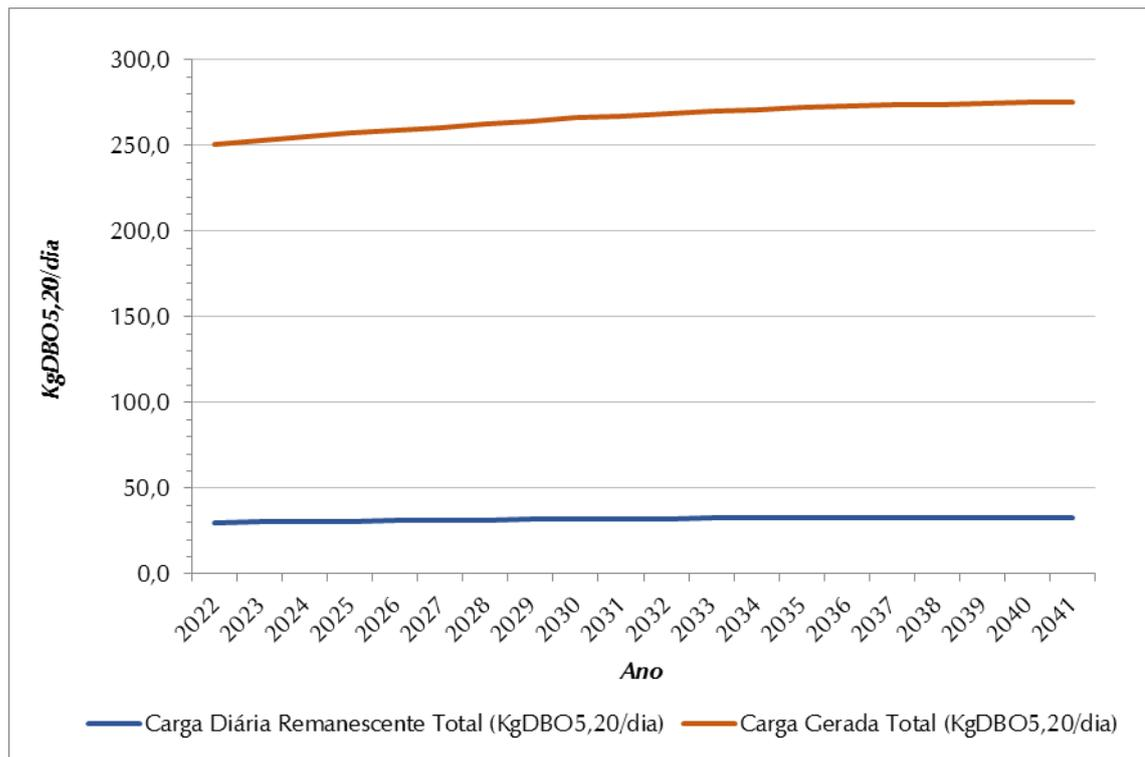
**Figura 8.4 - Evolução de Cargas Orgânicas (Kg DBO<sub>5,20</sub>/Dia)**
