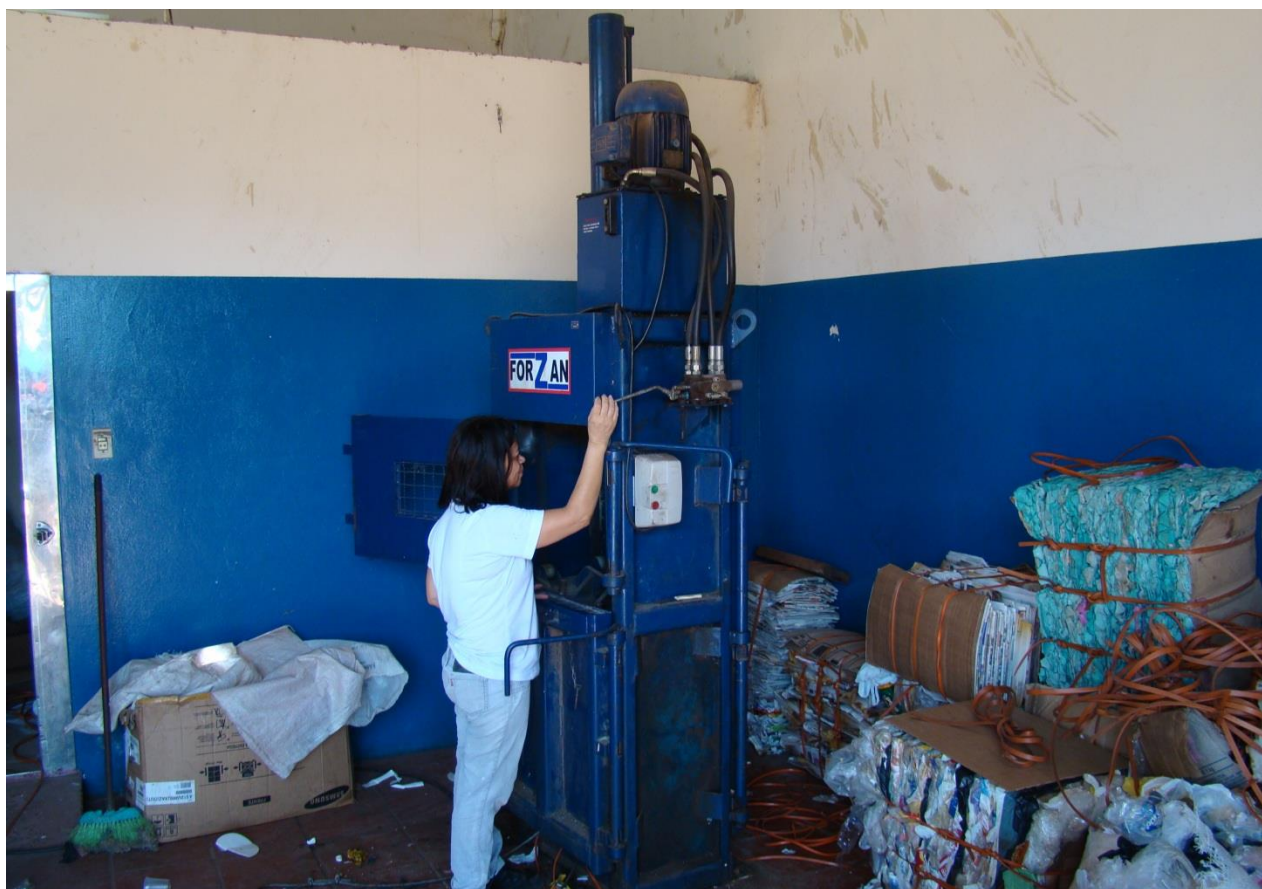
Imagem 15: Modelo de prensa para a compactação e enfardamento dos materiais recicláveis após sua separação.
