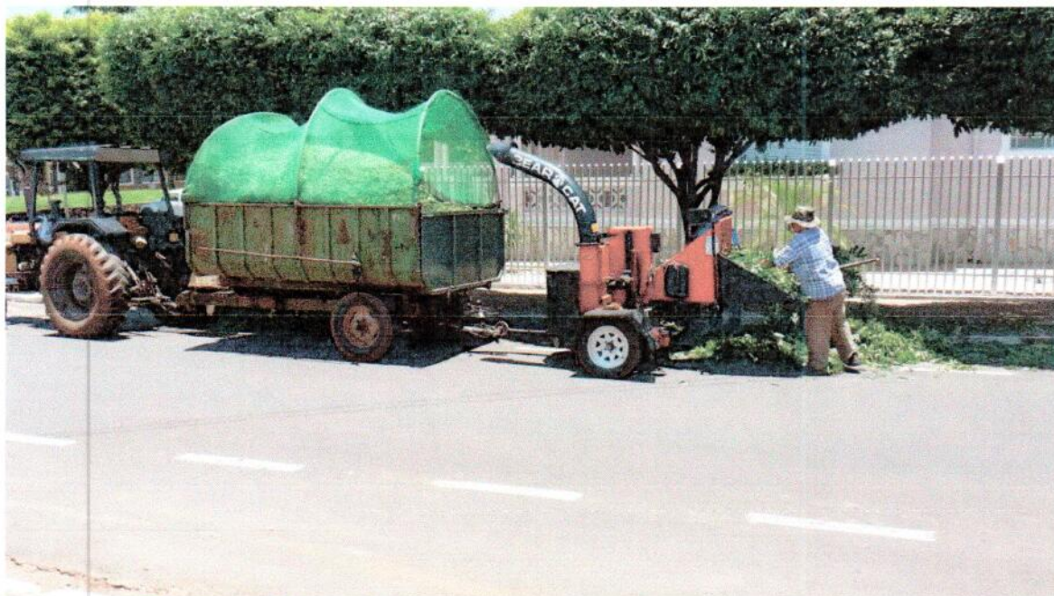
Figura 08: Coleta de galhos com caminhão e triturador acoplado
