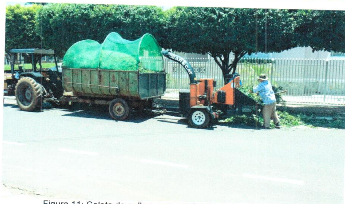
Figura 11: Coleta de galhos com caminhão e triturador acoplado
