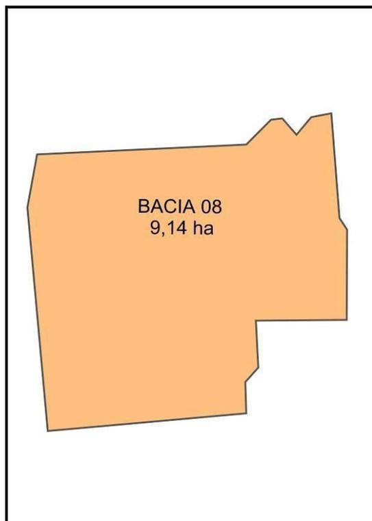
A área de drenagem da bacia 08 é de aproximadamente 9,14 ha. Foi diagnosticado no local uma rede de drenagem, localizado na Rua José Camargo do Nascimento, com a presença de bocas-de-lobo, que fazem a captação das águas pluviais e lançam na rede principal com diâmetro de 400mm. A dissipação ocorre em meia encosta, causando problemas aos moradores locais, com o início de processos erosivos próximo as residências.
