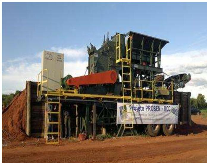
FIGURA 16: Equipamento de beneficiamento de resíduos da construção civil.
