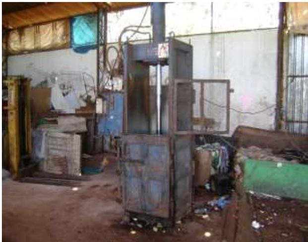
FIGURA 11: Prensa utilizada para enfiamento dos materiais recicláveis.
