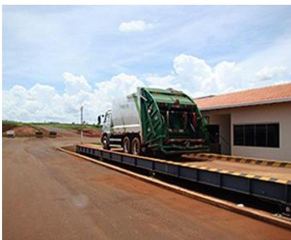
**Foto 3.4 – Vista de balança para pesagem dos resíduos sólidos no aterro sanitário particular em Uberaba/MG**
