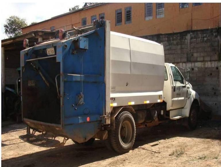
**Foto 15 – Caminhão coletor com basculamento de caçamba (Fonte: Andréia O. Assis)**
