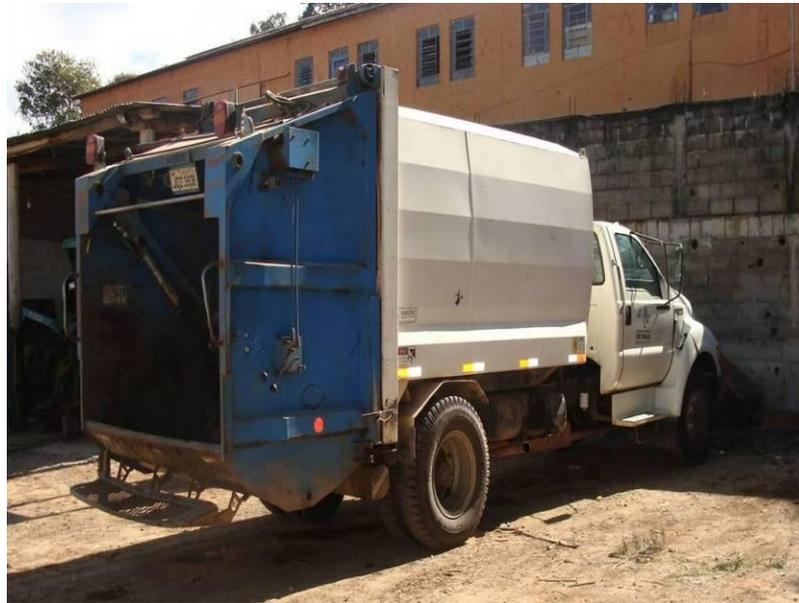
Foto 15 – Caminhão coletor com basculamento de caçamba
