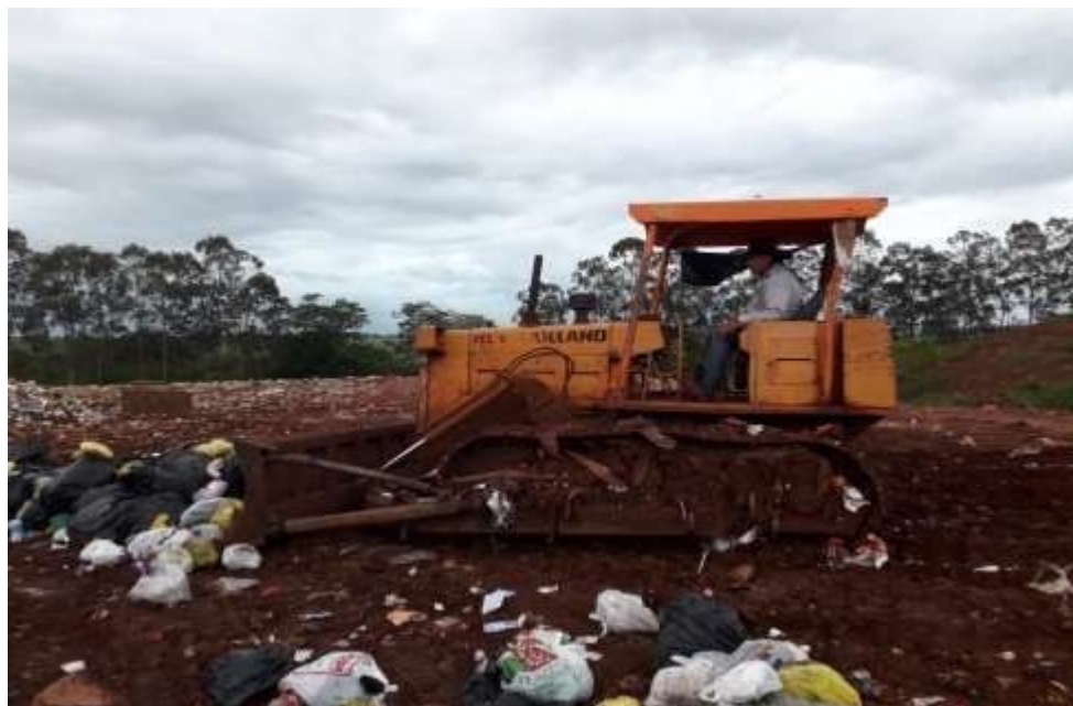
Figura 36. Registro da máquina esteira utilizada para compactação do solo e cobertura dos resíduos na célula do aterro sanitário.
