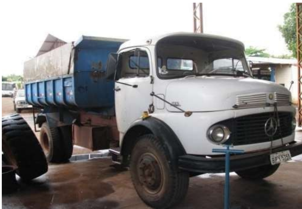
Figura 83. Caminhão Mercedes-Benz modelo 1113 (ano 1969) utilizado para transporte dos resíduos lenhosos até o local de destinação.
