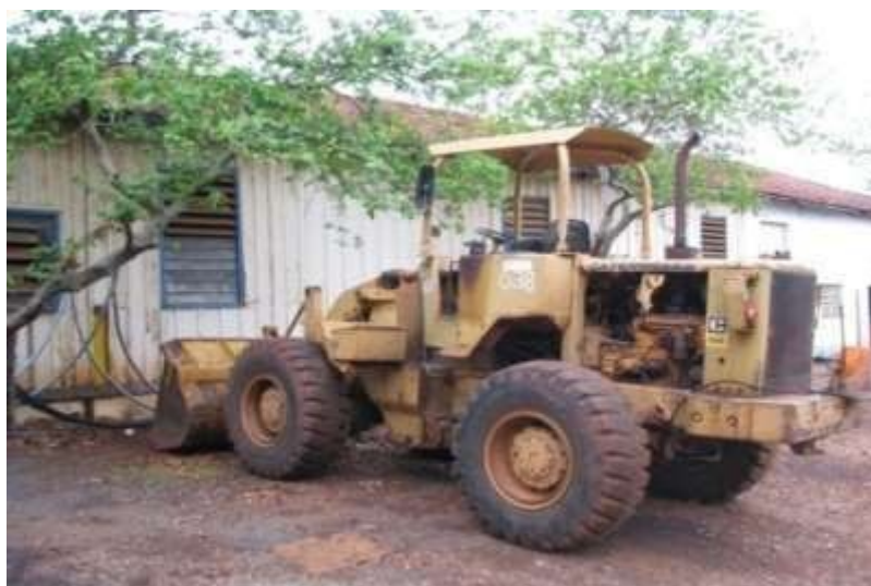
Figura 82. Registro da Pá carregadeira modelo CAT 930 ( ano 1977) utilizada para remoção dos resíduos lenhosos provenientes dos serviços de poda.
