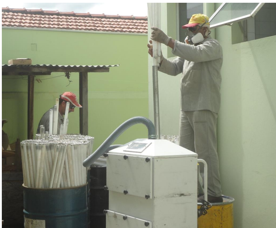
Figura 56 – Tratamento das Lâmpadas pelo Sistema "Papa-Lâmpadas".
