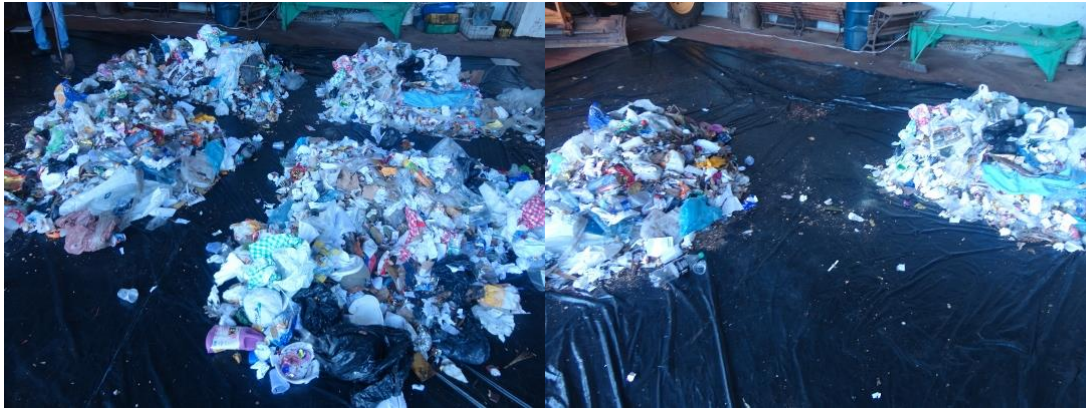
Figura 7 - Quarteamento e seleção de amostragem homogeneizada.
