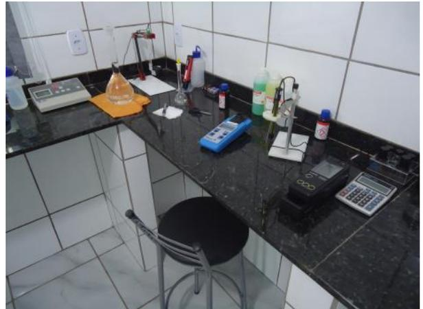
Foto 3.18 – Equipamentos utilizados para análises físico-químicas diárias
